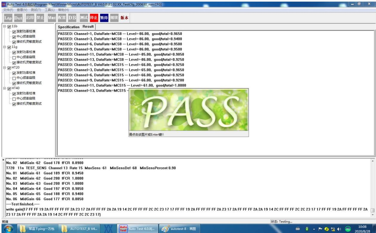
待测试完毕，请更换其它模块后可直接点击“测试”继续执行，并自动生成相应的 log。
