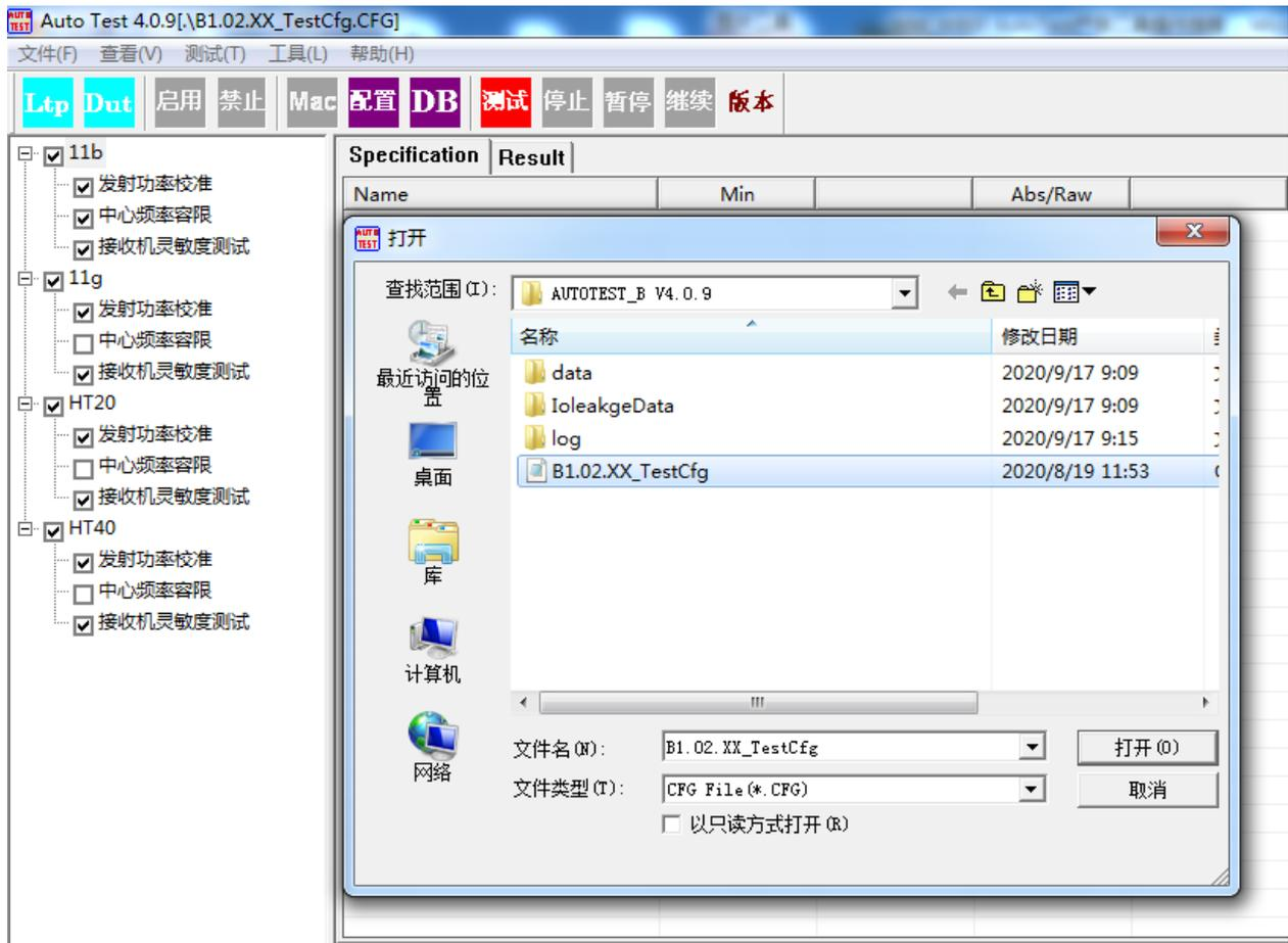
上述配置文件已默认勾选了测试项，如果想改变测试项内容，请双击对应测试项，在弹出的设置框里修改。比如双击 11b 下“发射功率校准”即弹出下面的设置框，根据自己意图进行相应勾选，最后点击“OK”。
