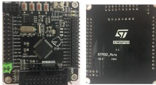
4. 模块 PIN 连接对端 stm32(PA9tx, PA10rx 作为打印口)：
